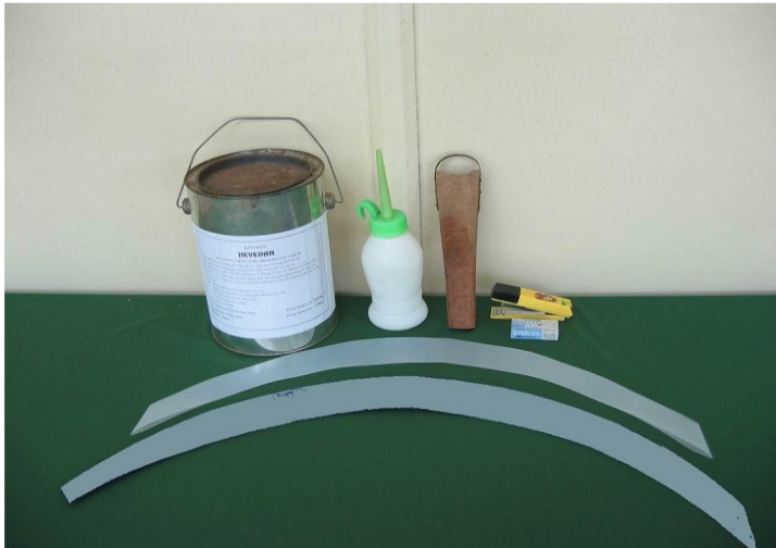
Hình 4.6: Dụng cụ gắn máng chắn nước mưa và các loại máng, mái che mưa
