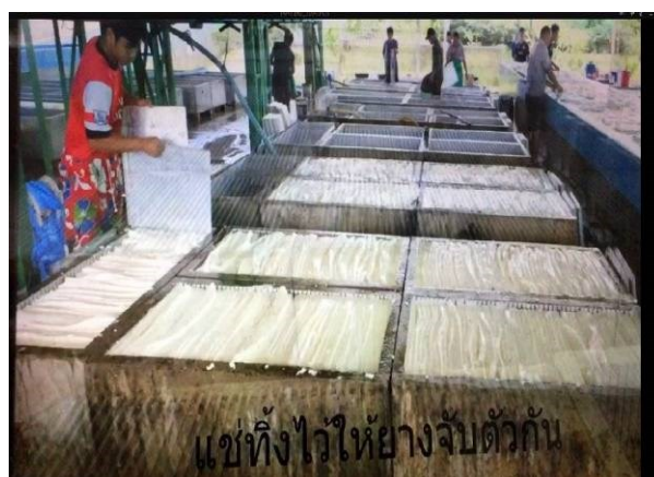
Hình 4.8: Đánh đông mù bằng hồ với tấm chắn rời được định vị
