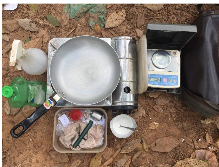
Hình 4.7: Dụng cụ xác định DRC tại vườn cây bằng phương pháp nướng chảo
