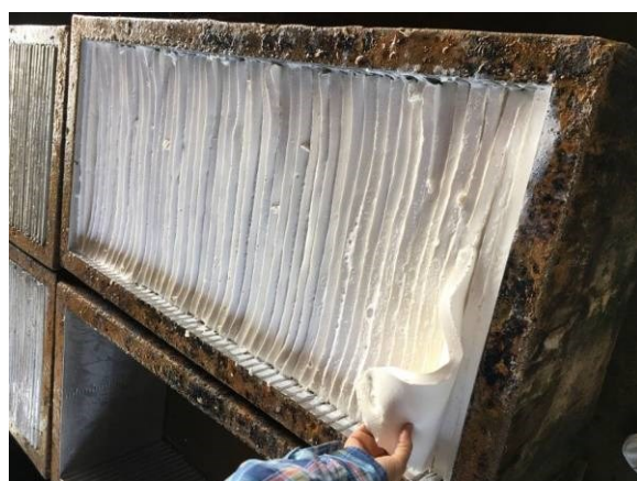
Hình 4.8: Đánh đông mù bằng hồ với tấm chắn rời được định vị
